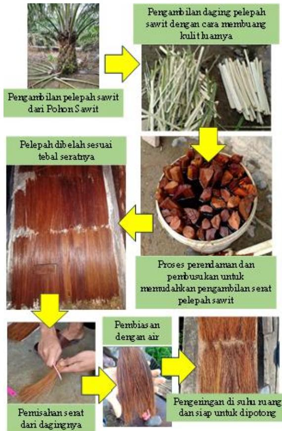
Gambar 2. Proses penyiapan serat pelepah sawit
